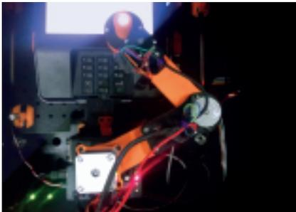
ATaaS® Automated Testing as a Service, es la suma de Hardware, Software y Servicio que permite Sistematizar y Automatizar el proceso de pruebas de sistemas de POS para asegurar su calidad antes de salir a producción.
